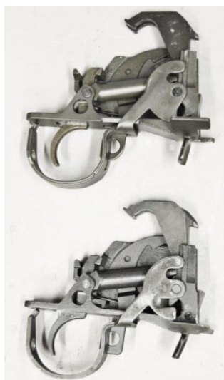
Abbildung 59 Oben: Unteres Gehäuseteil, Gewehr Springfield M 14
